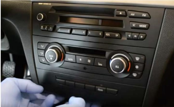
1. Ziehen Sie die Blende der Klimabedieneinheit an der unteren Seite leicht nach vorne, um sie von der Multimediabedieneinheit zu lösen.
