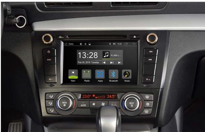
9. Verlegen Sie die diversen Anschlusskabel des Radical-Geräts sorgfältig im unteren Bereich der Radioschachts. Fixieren Sie das Gerät mit den beiden mitgelieferten Schrauben fest an der Mittelkonsole. Setzen Sie wieder alle Schrauben, die Sie zuvor gelöst haben, wieder ein und drehen sie fest. Befestigen Sie danach die Plastikverkleidungen wieder an dem gewohnten Platz.
