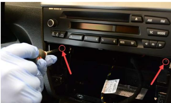
3. Lösen Sie mit Hilfe eines Schraubenziehers die beiden seitlichen Befestigungsschrauben des Original-Radios.
