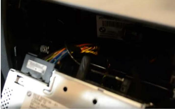
4. Um das Gerät vollständig aus dem Geräteschacht entfernen zu können, müssen Sie zuvor alle Steckanschlüsse (z.B. Hauptanschlusskabel, Antennenkabel, etc.) auf der Geräterückseite trennen.
