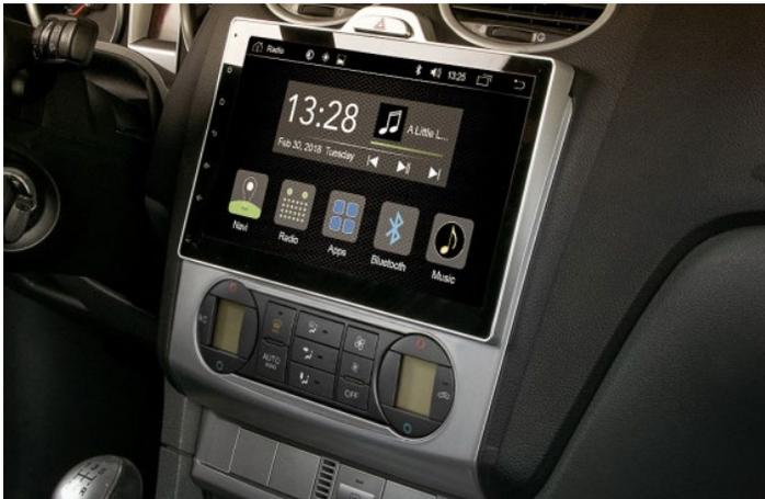
5. Verlegen Sie die diversen Anschlusskabel des Radical-Geräts sorgfältig im unteren Bereich der Radioschachts. Schieben Sie anschliessend das Radical-Gerät vorsichtig und mit dosierter Kraftaufwendung zurück in den Radioschacht. Drücken Sie den R-C10FD2 soweit nach innen, bis Sie hören wie die Verriegelung einklickt.
