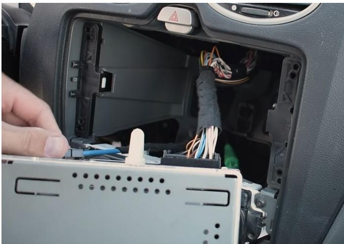
3. Um das Gerät vollständig aus dem Geräteschacht entfernen zu können, müssen Sie zuvor alle Steckanschlüsse (z.B. Hauptanschlusskabel, Antennenkabel, etc.) auf der Geräterückseite trennen.
