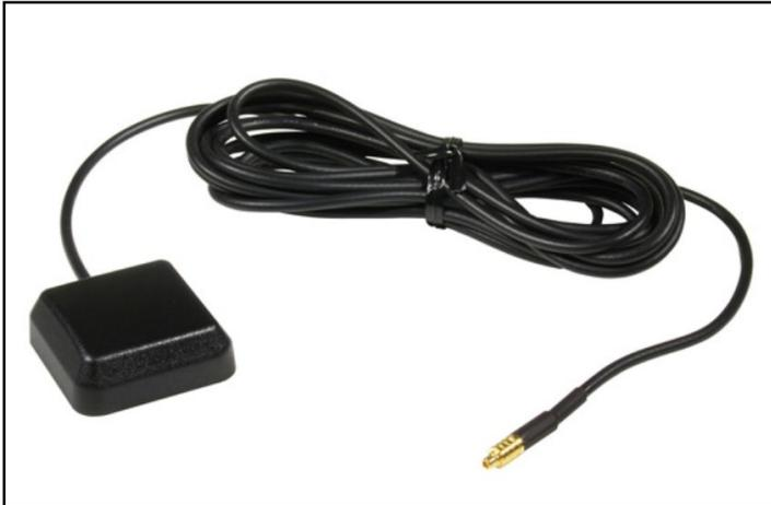
1. Montieren Sie die GPS-Antenne (Nr. 2) an einer geeigneten Stelle und achten Sie darauf, dass der GPS-Empfang nicht durch die Abschattung von metallischen Fahrzeugteilen negativ beeinflusst wird (Wärmeschutzverglasung etc.). Verlegen Sie das Anschlusskabel anschließend in den Radioschacht.
