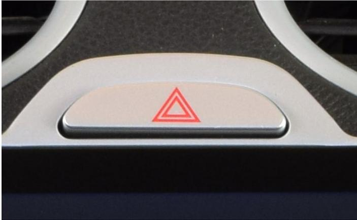
4. Entfernen Sie die Warnblinklicht-Taste mit dem Montagewerkzeug Kunststoffgriff (10), und ersetzen sie mit der mitgelieferten, passgenauen Taste für das RADICAL Gerät
