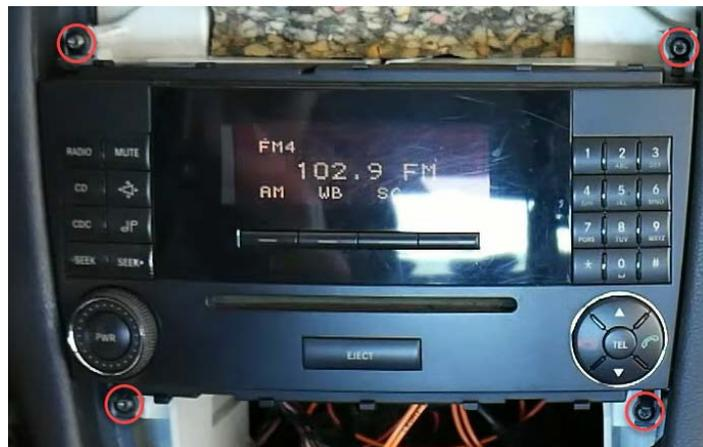
6. Anschliessend entfernen Sie die vier Halteschrauben des Originalradios.
