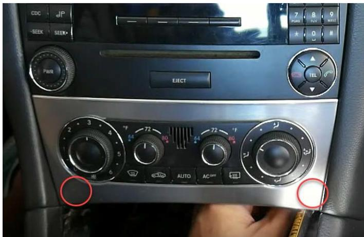
3. Nun müssen Sie die Klammern für die Blende in der Mittelkonsole lösen. Hierzu benötigen Sie einen dünnen langen Schlitzschraubenzieher. Nachdem Sie die Klammern gelöst haben, könnt Sie alle Stecker von den Bedienelementen abziehen.
