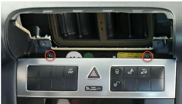
5. Nun lösen Sie mit einem Torxschraubenzieher die beiden Schrauben der Klimakontrolle.
