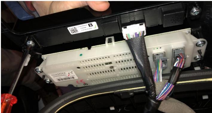
2. Lösen Sie die Kabel und entfernen Sie die beiden oberen Schrauben von der Klimatronik, um Radio und Klimatronik zu trennen.
