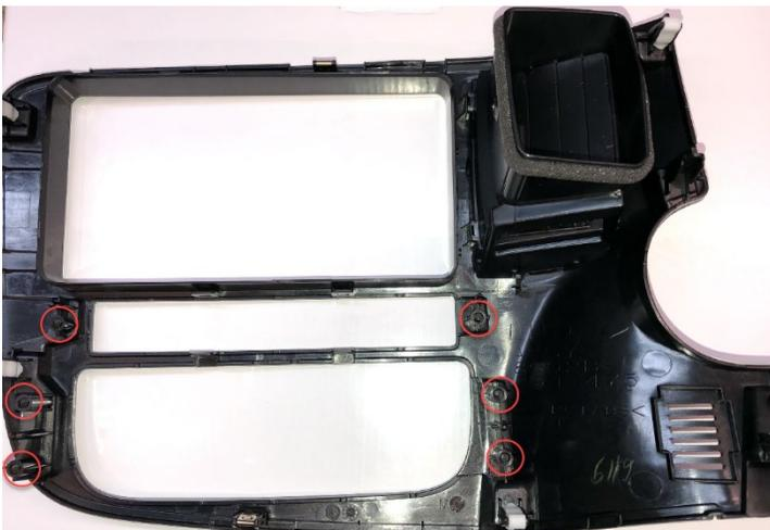
3. Entfernen Sie nun die hier rot markierten Schrauben vom Plastikrahmen, so dass Sie die Klimatronik-Anzeige und die ECO Anzeige vom Rahmen entfernen können.
