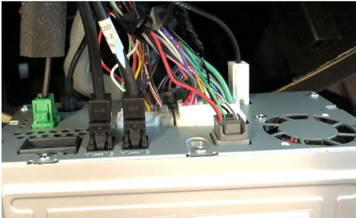
5. Lösen Sie einzeln alle hier abgebildeten Kabelverbindungen zum Original Radio.
