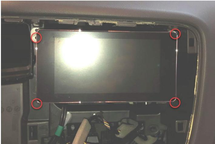
4. Lösen Sie nun die vier axial am Radio angebrachten Schrauben. Sie lösen damit das Radio aus der Rahmenverankerung und önnen es danach aus dem Schacht herausziehen
