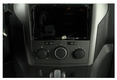
3. Um das Gerät vollständig aus dem Geräteschacht entfernen zu können, müssen Sie zuvor alle Steckanschlüsse (z.B. Hauptanschlusskabel, Antennenkabel, etc.) auf der Geräterückseite trennen. Legen Sie das Werksradio zur Seite, um es vor Beschädigungen zu schützen.
