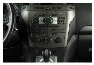
Lösen Sie mit dem beiliegenden Entriegelungswerkzeug (Nr. 14) Ihr Werksradio aus dem Radioschacht. Hierzu müssen die zwei Entriegelungsschlüssel eingeführt werden.
