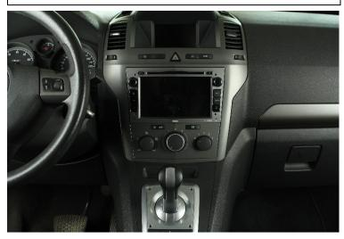
8. Verlegen Sie die diversen Anschlusskabel des Radical-Geräts sorgfältig im unteren Bereich der Radioschachts. Schieben Sie anschließend das Radical-Gerät vorsichtig und mit dosierter Kraftaufwendung zurück in den Radioschacht. Drücken Sie den R-C10OP2 soweit nach innen, bis Sie hören wie die Verriegelung einklickt.
