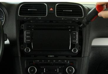
Fahren Sie mit dem Entriegelungswerkzeug einmal gegen den Uhrzeigersinn um den Plastikrahmen. Der Plastikrahmen sollte sich nun vollständig ablösen lassen. Lösen und entfernen Sie die vier Torx-Schrauben (T25) vom Originalgerät.
