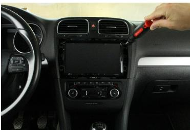
7. Verlegen Sie die diversen Anschlusskabel des Radical-Geräts sorgfältig im unteren Bereich der Radioschachts. Schieben Sie anschließend das Radical-Gerät vorsichtig und mit dosierter Kraftaufwendung zurück in den Radioschacht. Verschrauben Sie es wieder mit den vier Torx-Schrauben.
