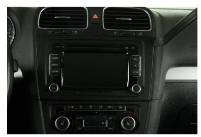
Hebeln Sie von rechts beginnend, vorsichtig den das Originalgerät umgebenden Plastikrahmen aus seiner gesteckten Verankerung. Verwenden Sie für diesen Schritt das im Lieferumfang enthaltene Kunststoff Entriegelungswerkzeug.
