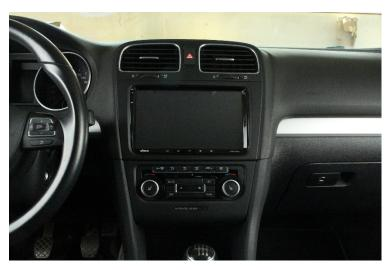
8. Nachdem das Radical-Gerät wieder verschraubt wurde, müssen Sie nur noch den Plastikrahmen aufstecken, um die Montage zu beenden.
