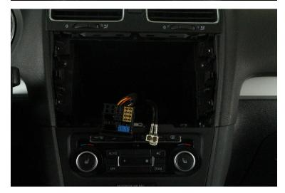
Ziehen Sie das Originalgerät nun vorsichtig aus dem Radioschacht. Trennen Sie anschliessend alle Kabel an der Geräterückseite.
