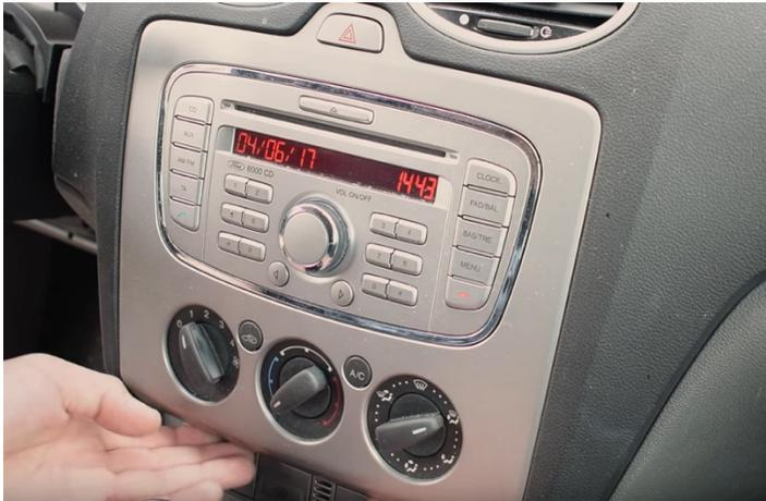
Ziehen Sie den Plastikrahmen an der unteren Seite leicht nach vorne, um sie von der Multimediabedieneinheit zu lösen.
