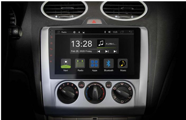
Verlegen Sie die diversen Anschlusskabel des Radical-Geräts sorgfältig im unteren Bereich der Radioschachts. Schieben Sie anschließend das Radical-Gerät vorsichtig und mit dosierter Kraftaufwendung zurück in den Radioschacht. Drücken Sie den R-C10FD1 soweit nach innen, bis Sie hören wie die Verriegelung einklickt.
