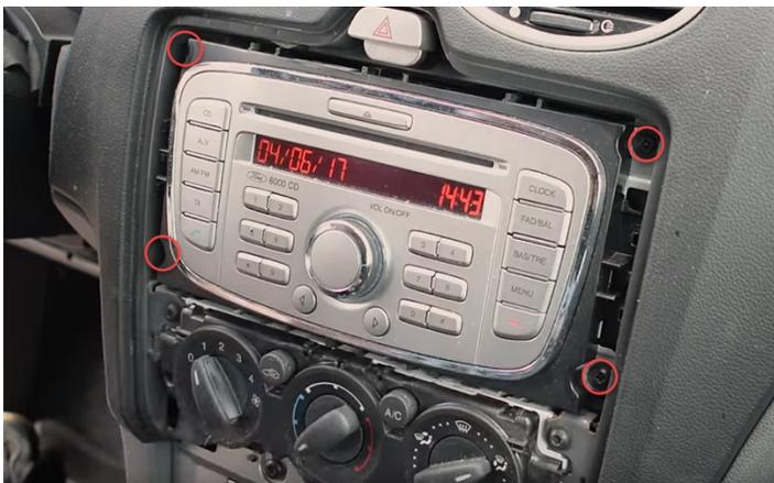
Lösen Sie mit Hilfe eines Kreuzschraubenziehers die vier Befestigungsschrauben des Originalradios.
