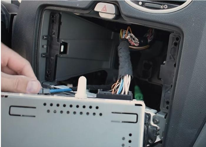
Um das Gerät vollständig aus dem Geräteschacht entfernen zu können, müssen Sie zuvor alle Steckanschlüsse (z.B. Hauptanschlusskabel, Antennenkabel, etc.) auf der Geräterückseite trennen.
