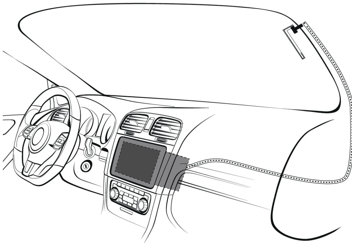
**WORKING OUT THE INSTALLATION POSITION OF THE ANTENNA**
