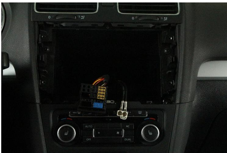
3. Ziehen Sie das Originalgerät nun vorsichtig aus dem Radioschacht. Trennen Sie anschliessend alle Kabel an der Geräterückseite.
