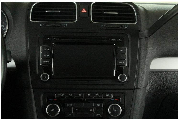
1. Hebeln Sie von rechts beginnend, vorsichtig den das Originalgerät umgebenden Plastikrahmen aus seiner gesteckten Verankerung. Verwenden Sie für diesen Schritt das im Lieferumfang enthaltene Kunststoff Entriegelungswerkzeug.
