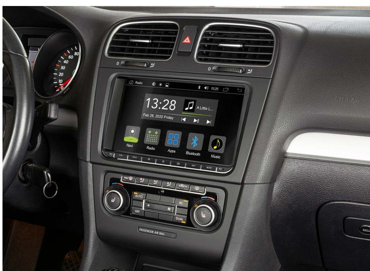
8. Nachdem das Radical-Gerät wieder verschraubt wurde, müssen Sie nur noch den Plastikrahmen aufstecken, um die Montage zu beenden.
