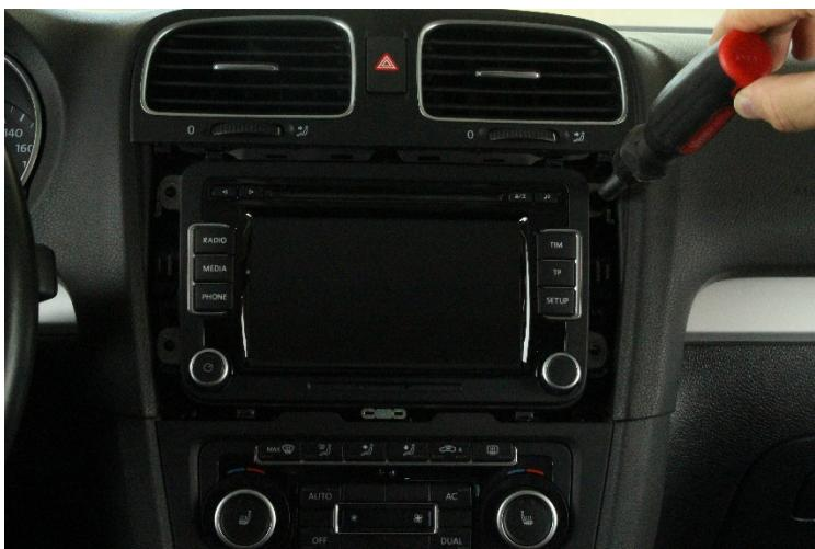
2. Fahren Sie mit dem Entriegelungswerkzeug einmal gegen den Uhrzeigersinn um den Plastikrahmen. Der Plastikrahmen sollte sich nun vollständig ablösen lassen. Lösen und entfernen Sie die vier Torx-Schrauben (T25) vom Originalgerät.
