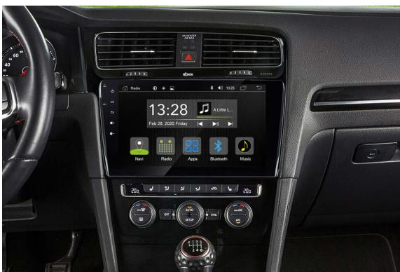
11. Verlegen Sie die diversen Anschlusskabel des Radical-Geräts sorgfältig im unteren Bereich der Radioschachts. Schieben Sie anschliessend das Radical-Gerät vorsichtig und mit dosierter Kraftaufwendung zurück in den Radioschacht. Drücken Sie den R-C12VW2 soweit nach innen, bis Sie hören wie die Verriegelung einklickt.
