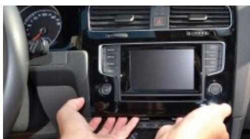
2. Ziehen Sie die Radioblende an der unteren Seite leicht nach vorne, um sie von der Multimediacbedieneinheit zu lösen.
