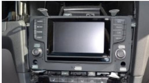
6. Verwenden Sie die im Lieferumfang des Radical-Gerätes enthaltenen Entriegelungsbügel (No. 15), um die Multimedia Bedieneinheit zu entfernen. Entriegeln Sie anschließend alle Stecker an der Rückseite und entfernen Sie die Multimedabedieneinheit
