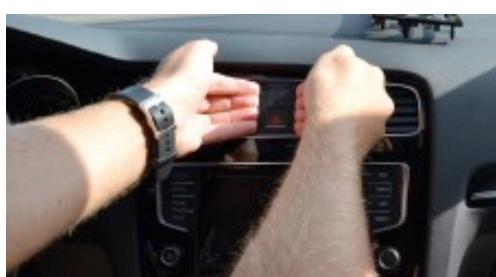
3. Als nächstes ziehen Sie die Schalttereinheit mit der Taste für den Warnblinker nach vorne heraus, um anschließend die Anschlussstecker zu entriegeln.
