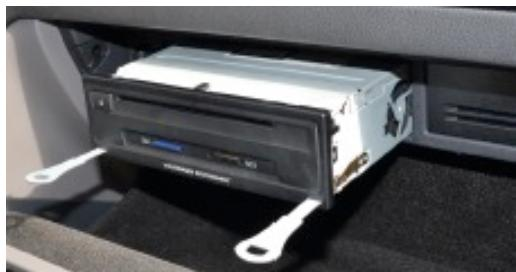
7. Falls Ihr Fahrzeug im Handschuhfach mit einem Steuergerät für die Informationselektronik ausgestattet ist, müssen Sie dieses zuerst entfernen. Verwenden Sie die Entriegelungsbügel und ziehen Sie das Steuergerät soweit heraus, um alle Stecker an der Rückseite zu entriegeln und entfernen Sie das Steuergerät.
