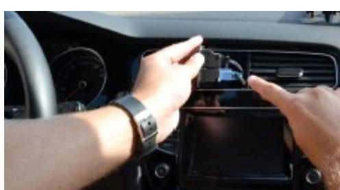
4. Entnehmen Sie die Schalttereinheit, um dann die Radioblende zu entfernen.
