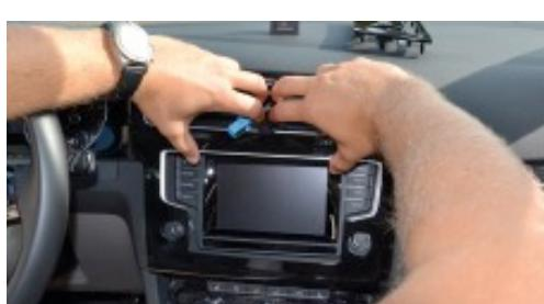
5. Greifen Sie dazu in die Öffnung der zuvor entfernten Schalttereinheit, um die Radioblende mit einem kräftigen Ruck nach vorne zu lösen. Bei der Entfernung der Radioblende müssen Sie darauf achten, dass die Steckverbindungen der Radioblende am Übergang zum Kombiinstrument vorsichtig entriegelt werden.
